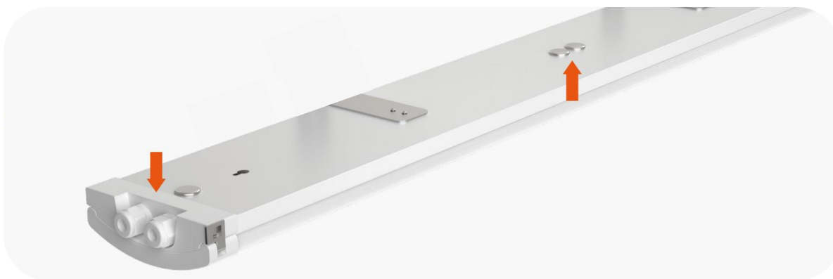
Kabel kan enten føres inn fra siden (begge sider) eller fra oversiden (en i hver ende + to stk. sentrert på baksiden). Alle kabelinngangene er med gummipakning.
